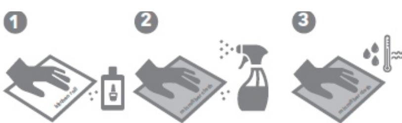
Удаление пятен бумажным полотенцем и ацетоном (жидкость для снятия лака)
